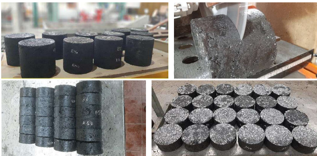
Figura 1 Secuencia de obtención de probetas para ensayos.
